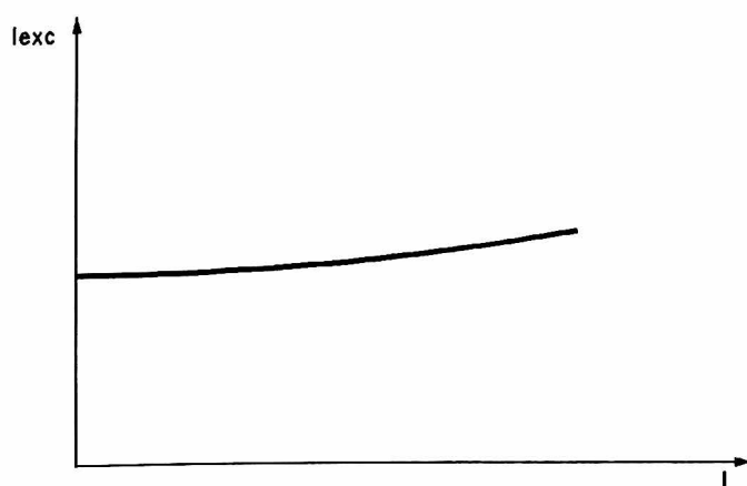
Obr1.10 Regulační charakteristika samostatného buzení d.c. generatoru
