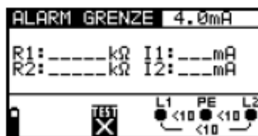
Obr. 5.6: Menu pro zkoušení přístrojů kontroly izolace
