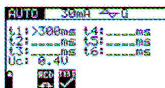
Obr. 5.28: Výsledky kroku 1 automatické zkoušky RCD
