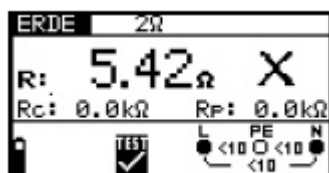
Obr. 5.52: Příklad výsledku měření odporu uzemnění
